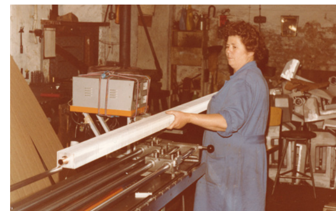
Die Fertigung der Variotherm Heizleisten erfolgte größtenteils händisch und unter großem Kraftaufwand
